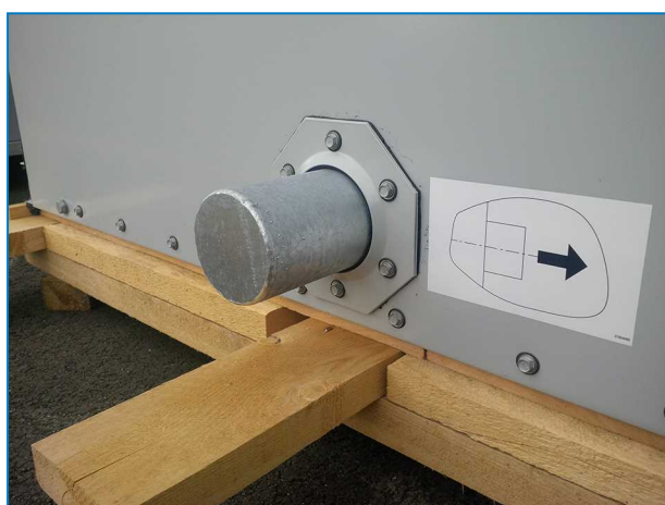
Lägre blockerad slingkoppling på evaporativa kondensorer.
