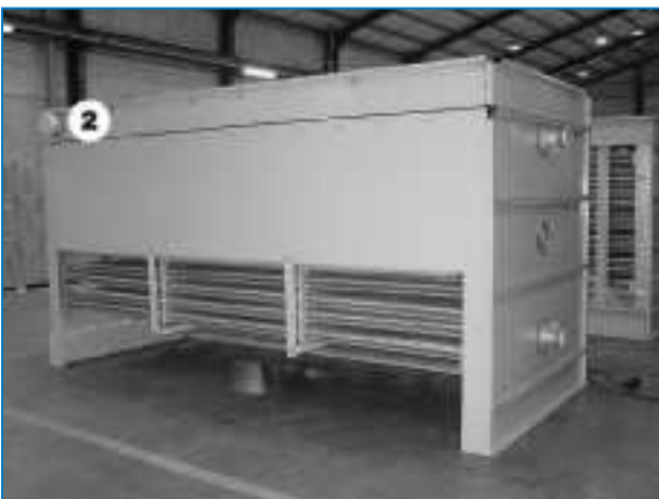
Pompleidingen verbinding op batterijsectie
