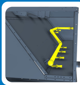
Sistema de barrido de la balsa
