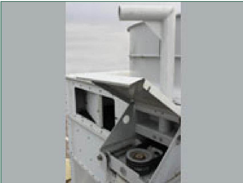
Mit dem Motor-Entfernungs-Davit ist das **Heben oder Senken** Ihres Motors aus dem/in das Gerät von oben ganz einfach!
