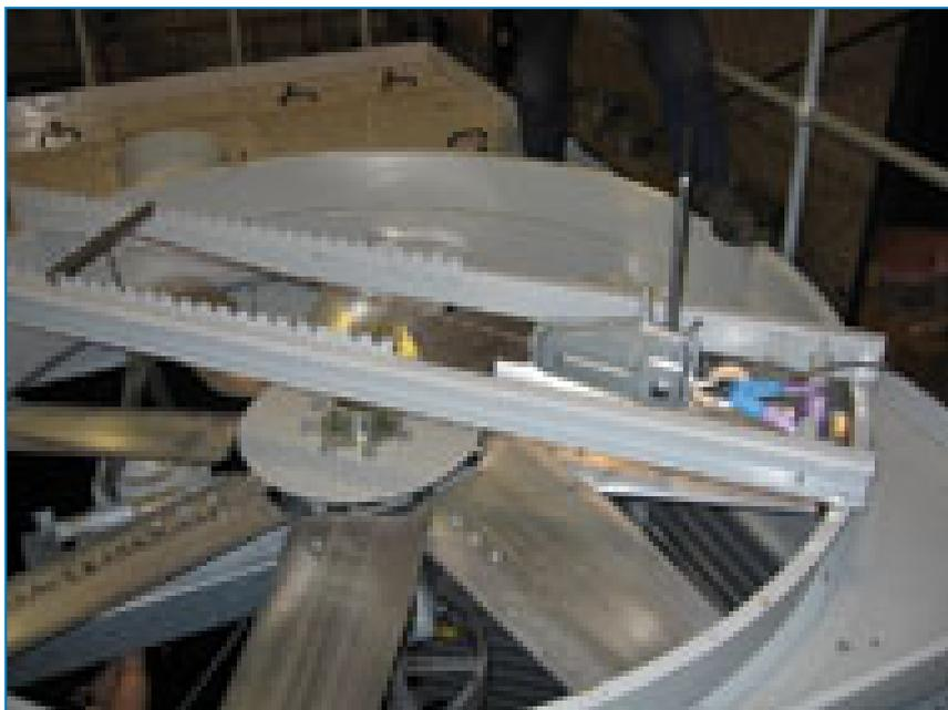
El ligero sistema de extracción mecánica del equipo **le ayuda a desmontar o instalar con facilidad motores de ventiladores o cajas de engranajes.**
