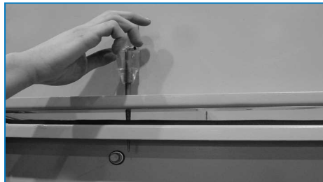
Использование штифта для выравнивания резьбовых отверстий
