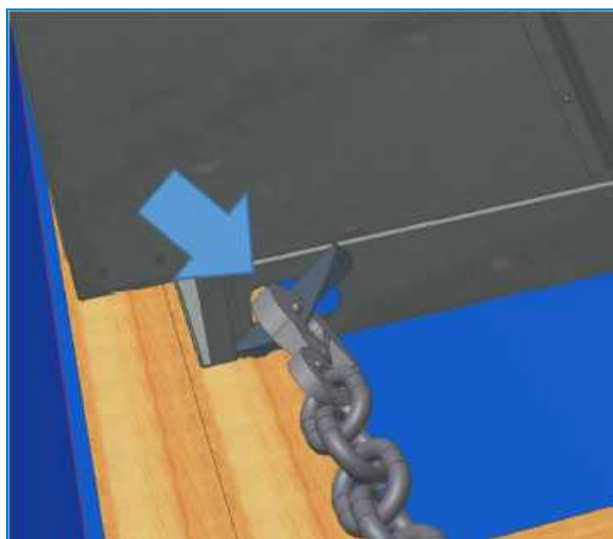
Извлечение агрегата из контейнера
