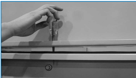
Verwendung des Treibdorns zur Ausrichtung der Schraublöcher
