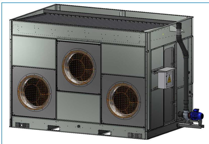
*Tutte le protezioni ventilatore sono state montate, l'unità è pronta per la messa in funzione.*
