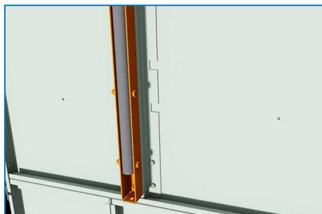
Installare tutti i montanti verticali con le staffe fornite e serrare con bulloneria M10.
