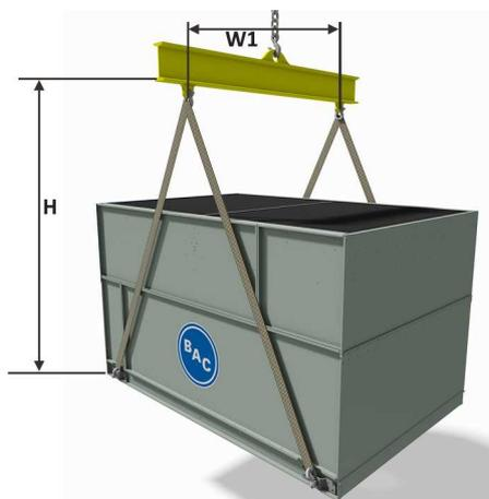
Montaggio della sezione superiore
