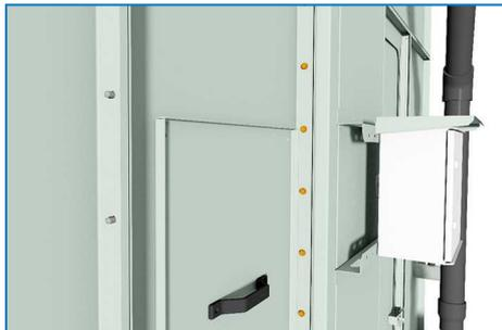
Sollevere l'attenuatore in aspirazione in posizione. Assicurarsi che i fori di fissaggio dell'attenuatore in aspirazione siano allineati ai fori dell'unità. Fissare con tappi.
