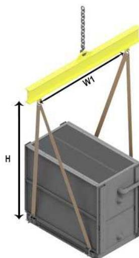
Montaggio della sezione superiore (piccole unità)
