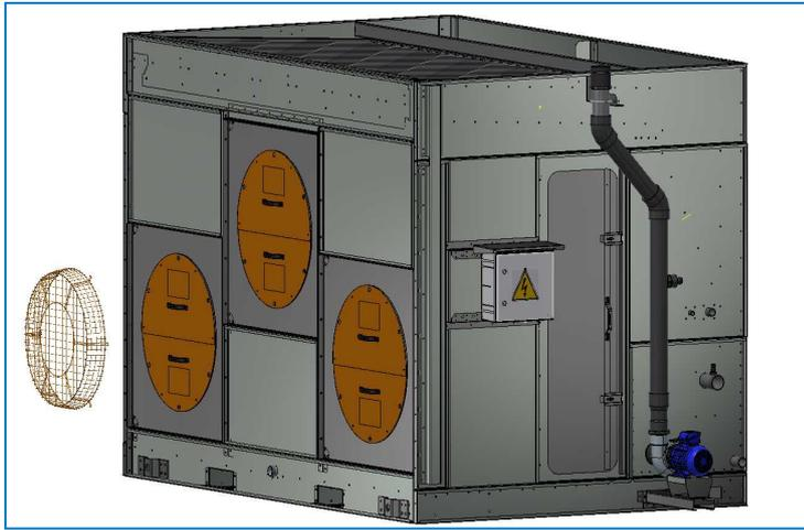
*Sostituire il coperchio ventilatore con la protezione ventilatore.*
