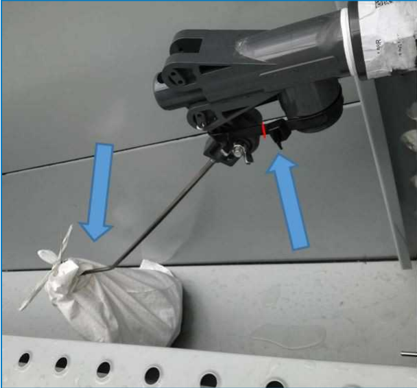
Fixation et emballage du flotteur sphérique
