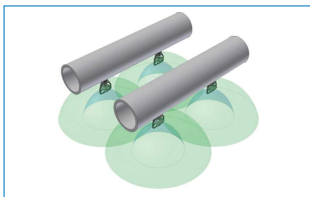
Distribution par pulvérisation de condenseurs
