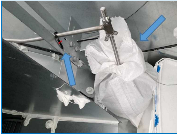
Fissaggio e avvolgimento della palla galleggiante
