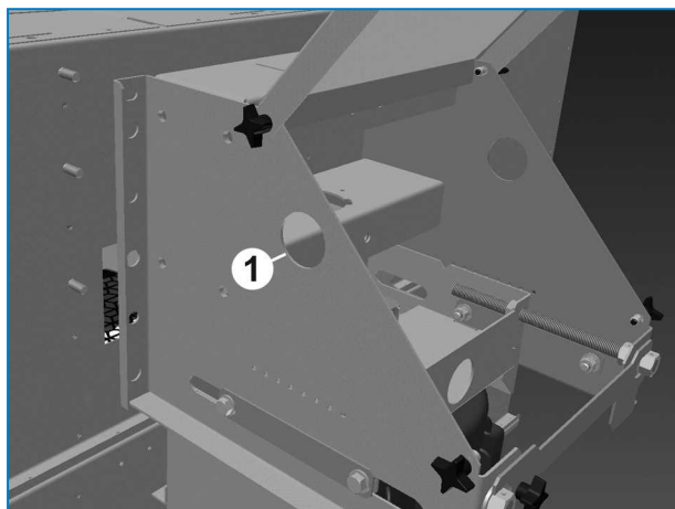
Montaggio del motore esterno - Fase 1
