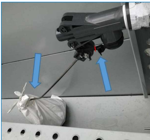
Befestigung und Umhüllung der Schwimmerkugel
